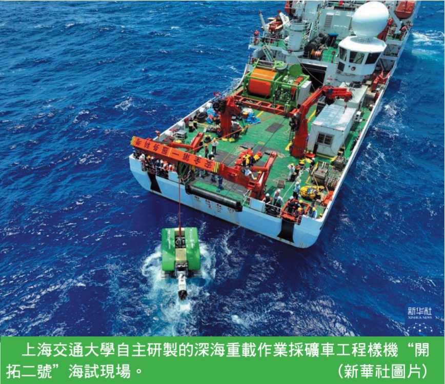
上海交通大學自主研製的深海重載作業採礦車工程樣機“開拓二號”海試現場。（新華社圖片）
